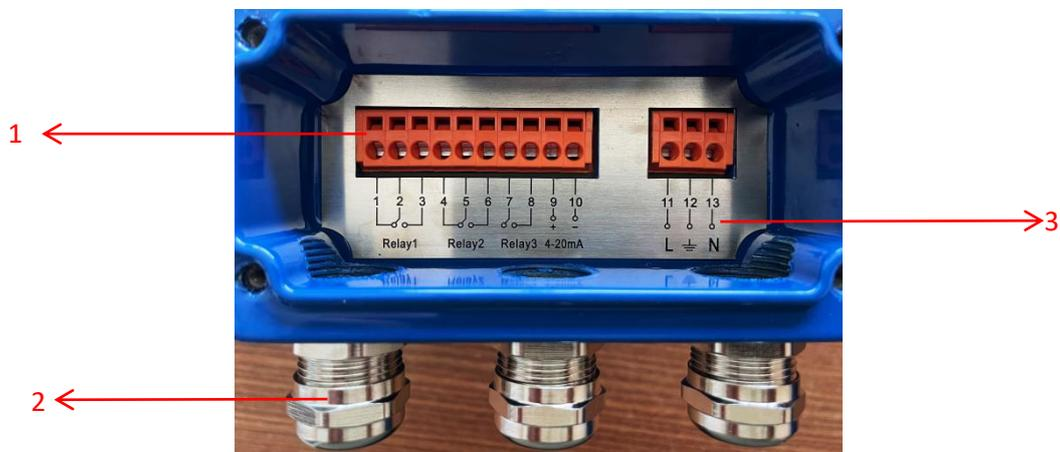
图 1 煤灰传感器端子图示
