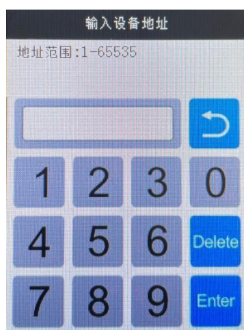
图 4-7 地址码输入界面
